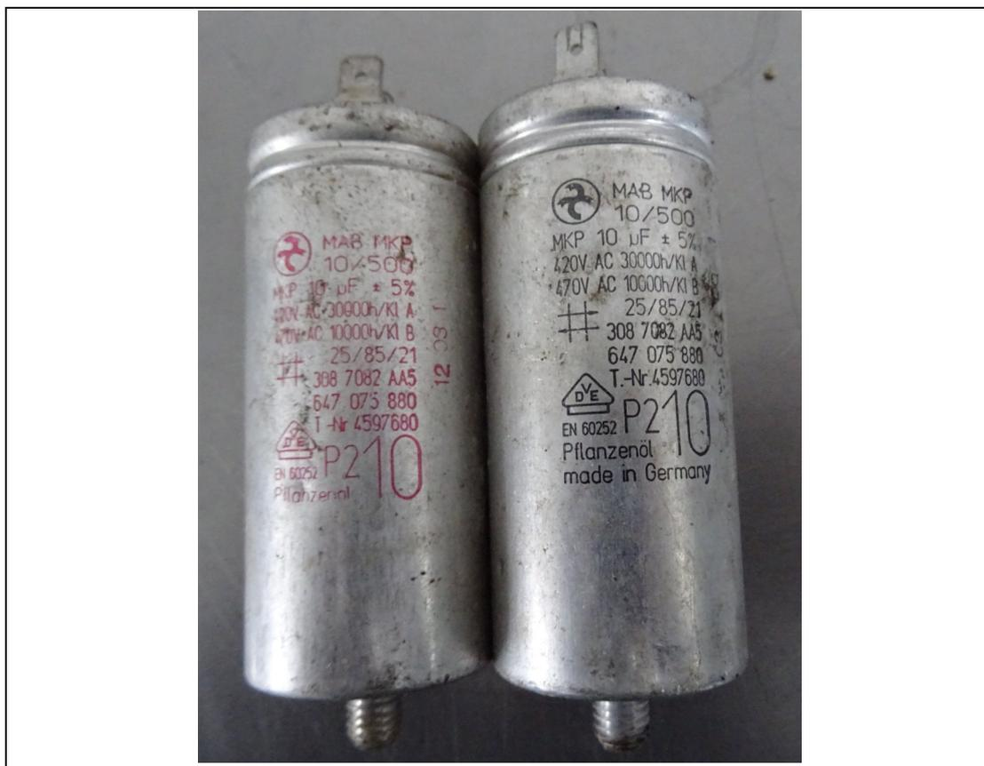
Abbildung 4: Beispiel zweier Kondensatoren mit Modellbezeichnung MAB MKP 10/500
