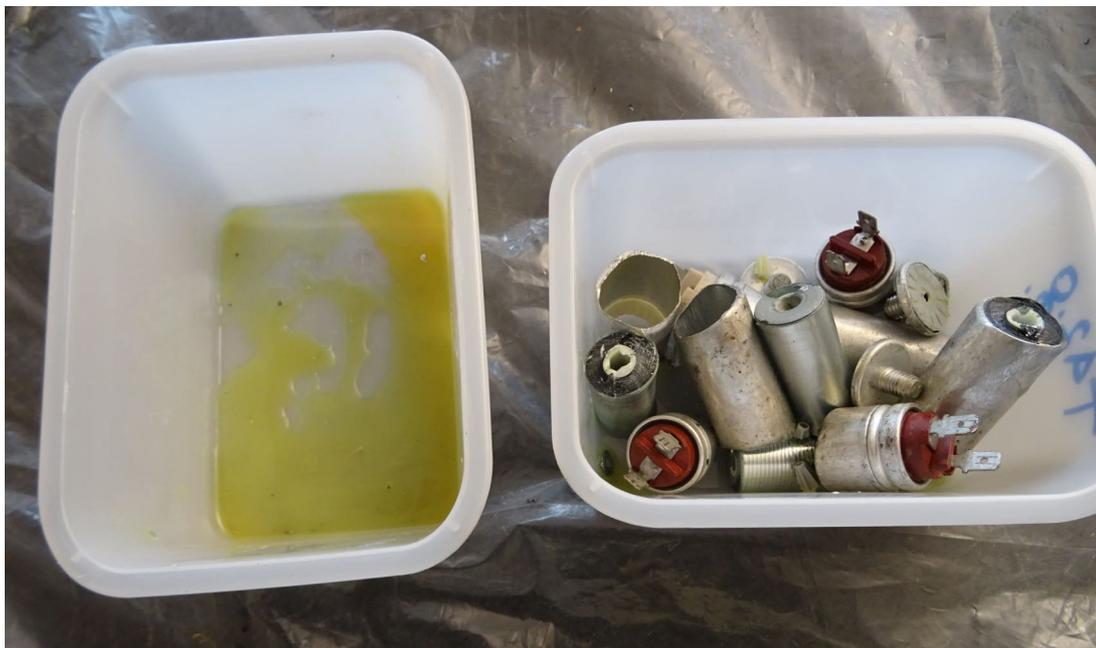
Abbildung 15: Separierte Probe des Kondensatormodells Nr. 109
