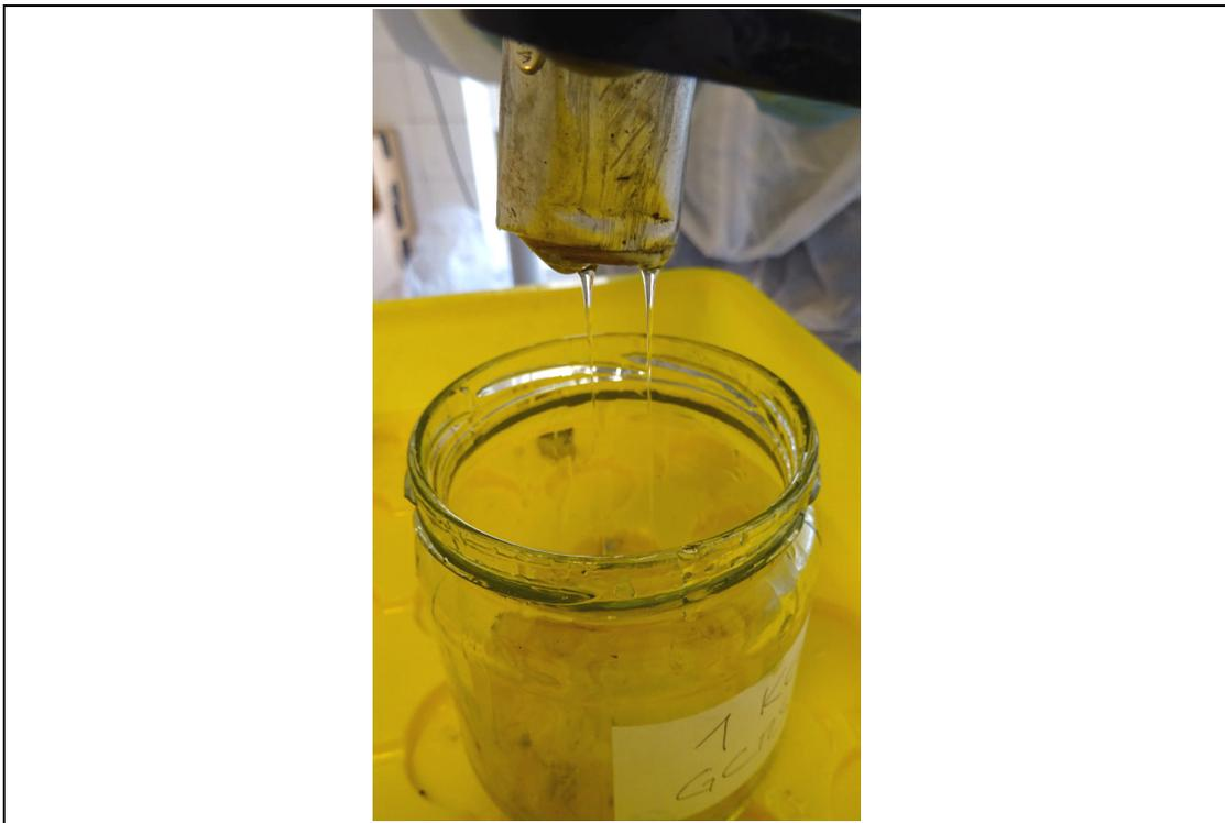
**Abbildung 11: Flüssigkeitsaustritt aus ungepoltem zylindrischem Kondensator nach dem Aufschneiden**
