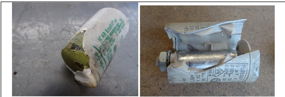
Abbildung 21: Geöffneter KS-Kondensator ohne flüssige Inhaltsstoffe
