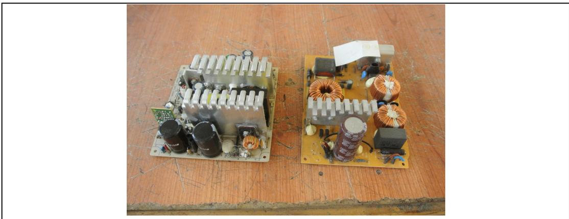
Abbildung 6: Interne Netzteile aus Elektro- oder Elektronikgeräten
