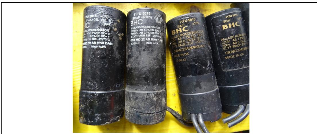
Abbildung 22: Motorstart-Elektrolyt-Kondensatoren in schwarzen Kunststoffgehäusen
