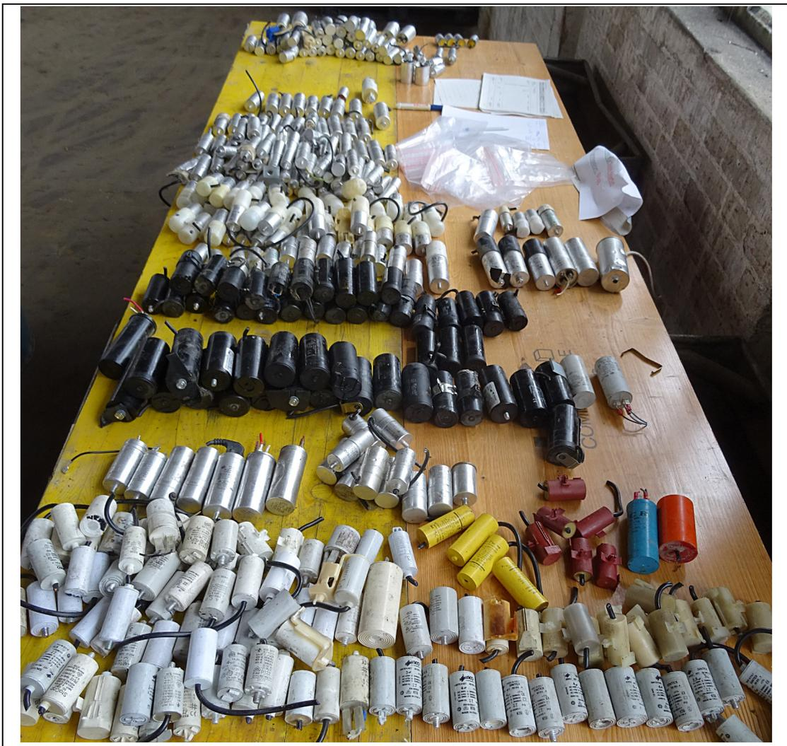
Abbildung 1: Ungepolte zylindrische Kondensatoren mit Plastik- oder Alugehäuse
