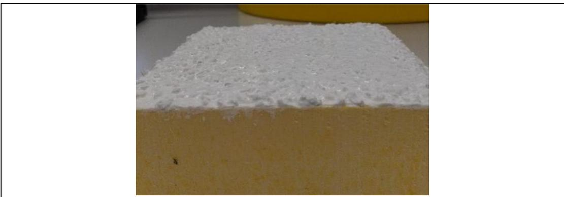
**Abbildung 1: XPS-Prüfkörper mit Putz beschichtet.**
